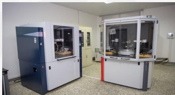
Дифракционный рентгенометр с высокой разрешающей способностью D8 Discover
