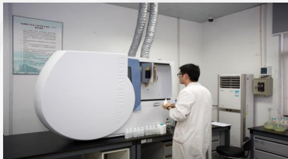
Атомно-эмиссионный спектрометр с индуктивно связанной плазмой (ICP)
