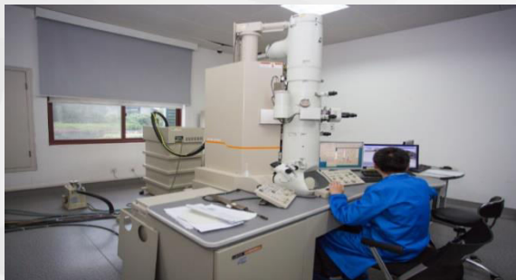
Трансмиссионный электронный микроскоп JEM-2100
