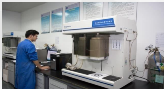
Автоматический абсорбционный аппарат
